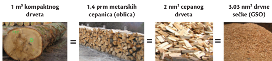
Slika 2. Primer korišćenja koeficijenta za konverziju jedinica mere različitih drvnih sortimenata u metre kubne kompaktnog drveta. 6
